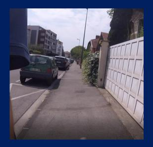
Et encore ici une pente transversale mesurée à 15%, bien supérieur aux 2% règlementaire.
